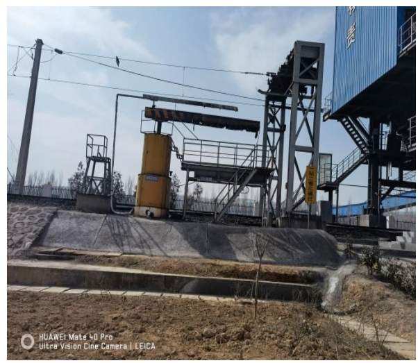
装车后煤炭表面喷洒粘结剂设备
